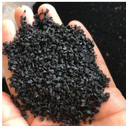
Illustration 19 — granulés de caoutchouc provenant de pneus de voiture recyclés (Photo de Michal Ďurčina sous licence CC BY-SA 4.0.)
