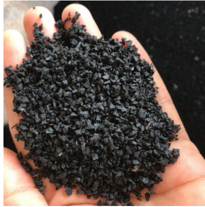
Abbildung 19 – Gummigranulat aus recycelten Autoreifen (Bild von Michal Ďurfina, lizenziert unter CC BY-SA 4.0)
